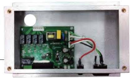
AC控制基板 AC motor controller
